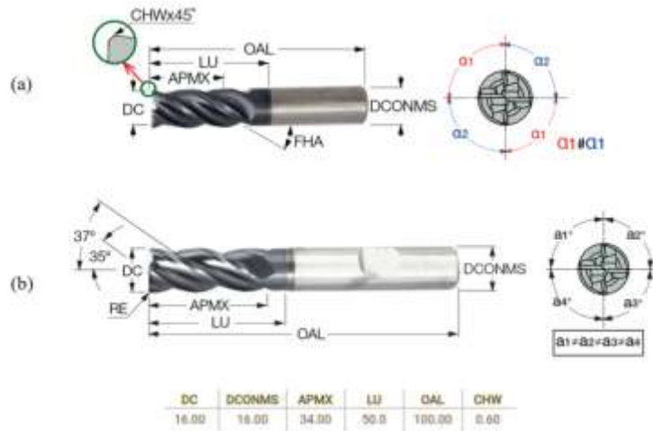
Şekil 1. Parmak frezelerin teknik özellikleri a) EC-E4L (38° helis açısı) ve b) EC-H4L (35°-37° helis açısı)
